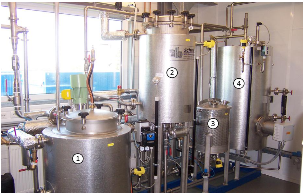
Abb. 3: Pilot-Aufschlussanlage im Technikum des PFI. 1 = Vorlagebehälter; 2 = Aufschlussreaktor; 3 = Auffangbehälter; 4 = Dampferzeuger
